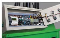
Современная система управления на PLC
